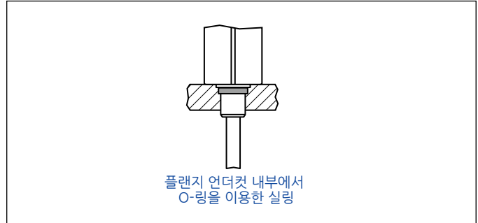
그림. 13: 나사 가공 플랜지, Raised-face 타입에서 가능한 실링 방법
