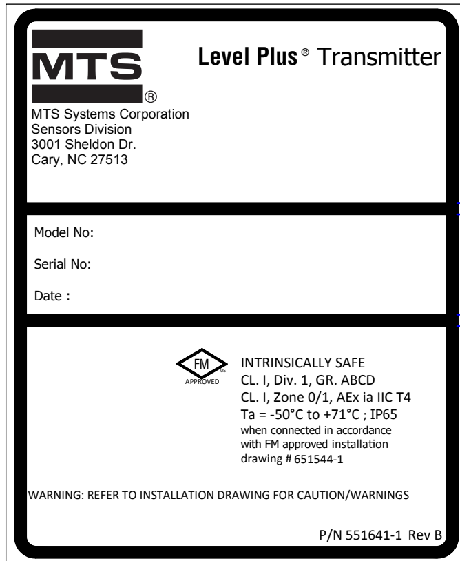
図 16：本質的安全 FM ラベル、HART®、NEMA ハウジング
