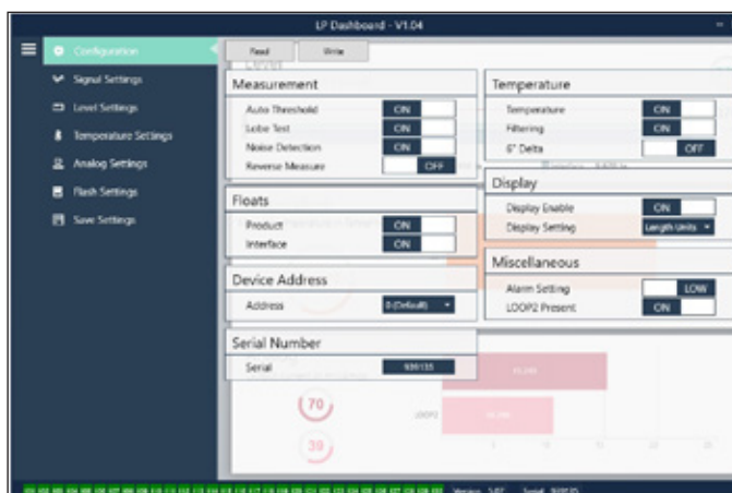
Fig. 5 : La configuration de l'application spécifique du transmetteur de niveau s'effectue dans l'onglet Configuration.
